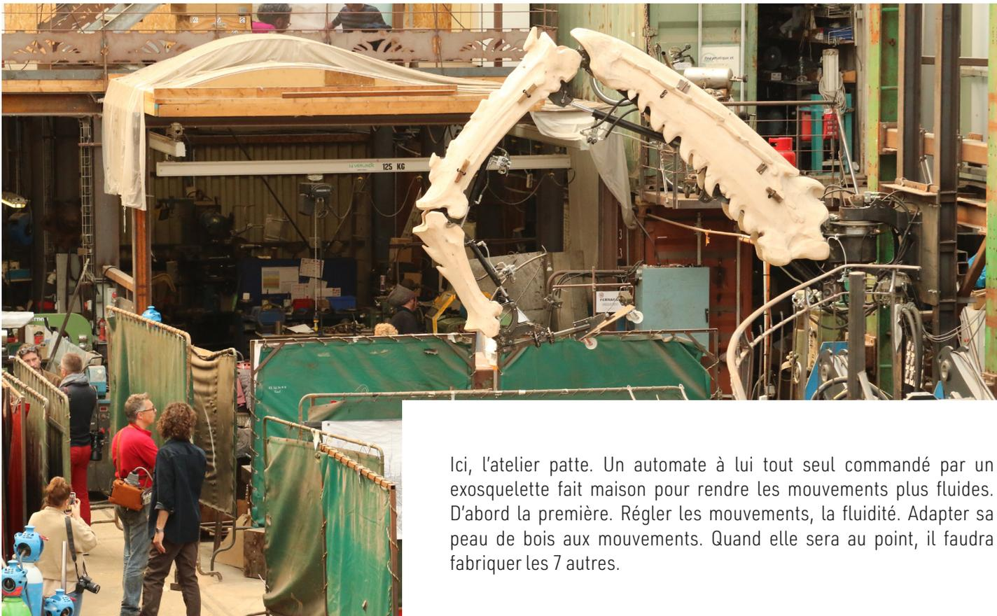
Ici, l'atelier patte. Un automate à lui tout seul commandé par un exosquelette fait maison pour rendre les mouvements plus fluides. D'abord la première. Régler les mouvements, la fluidité. Adapter sa peau de bois aux mouvements. Quand elle sera au point, il faudra fabriquer les 7 autres.
